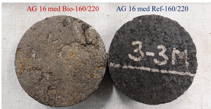
Figur 56. Provkroppar (AG 16-asfaltmassor med 160/220 bindemedel) efter MIST-konditioneringen.
