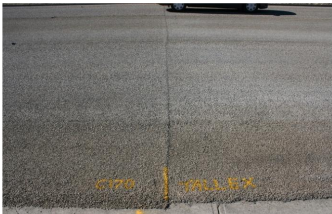
Figur 8. Färdigt belagd ytbehandling på provvägen i Australien: till vänster med konventionellt bitumen och till höger med biobindmedel (Urquhart & Malone 2013).
