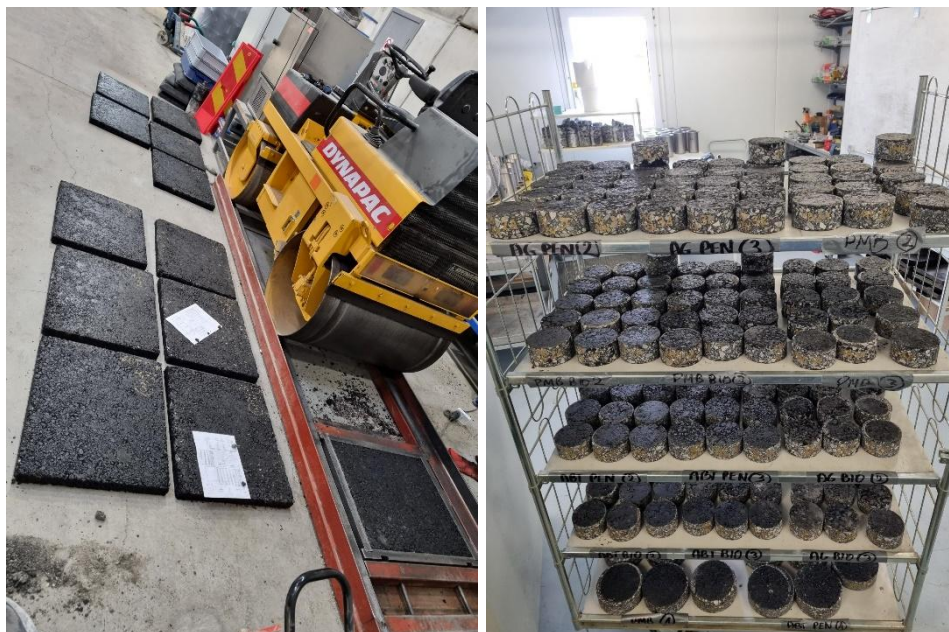
Figur 14. Tillverkning av provkroppar. Till vänster: packning av asfaltsplattor på Skanskas labb i Västerhaninge; till höger: borrhärdar från plattorna. Foton: Patryk Witkiewicz.
