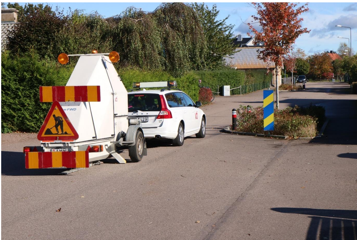
Figur 8-22. Fallviksmätning på standardkonstruktion i Munka Ljungby (Foto Fredrik Hellman).
