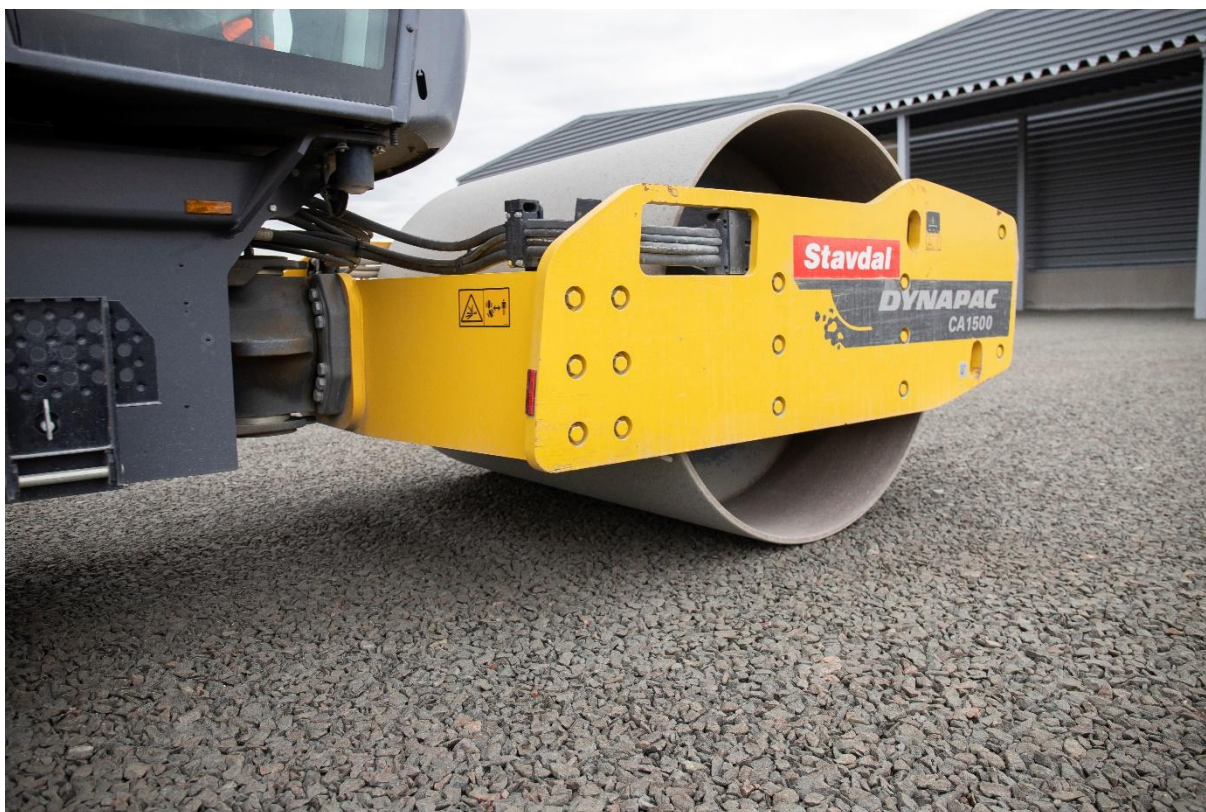
Figur 5-1 Att packningen utförs korrekt är av yttersta vikt för ett gott resultat (Foto Benders AB).
