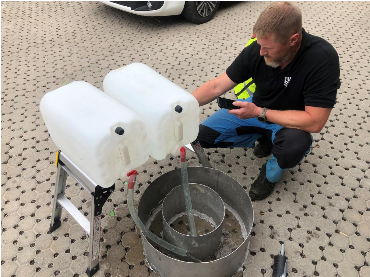
Figur 10-1 Infiltrationsmätning med dubbelringsinfiltrrometer (Foto Björn Schouenborg).
