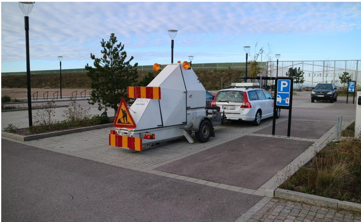
Figur 8-14. Fallviktsmätning på gräsarmerad parkeringsyta i Vellinge. Standard konstruktion med asfalt i anslutning till p-ytorna har använts som referens (Foto Fredrik Hellman).
