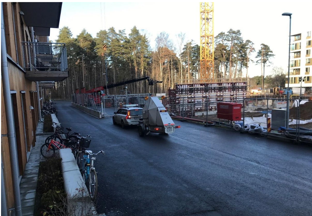
Figur 8-8. Fallviktsmätning på obundet bärlager i Rosendal etapp 2 på Dekangatan (Foto Fredrik Hellman).
