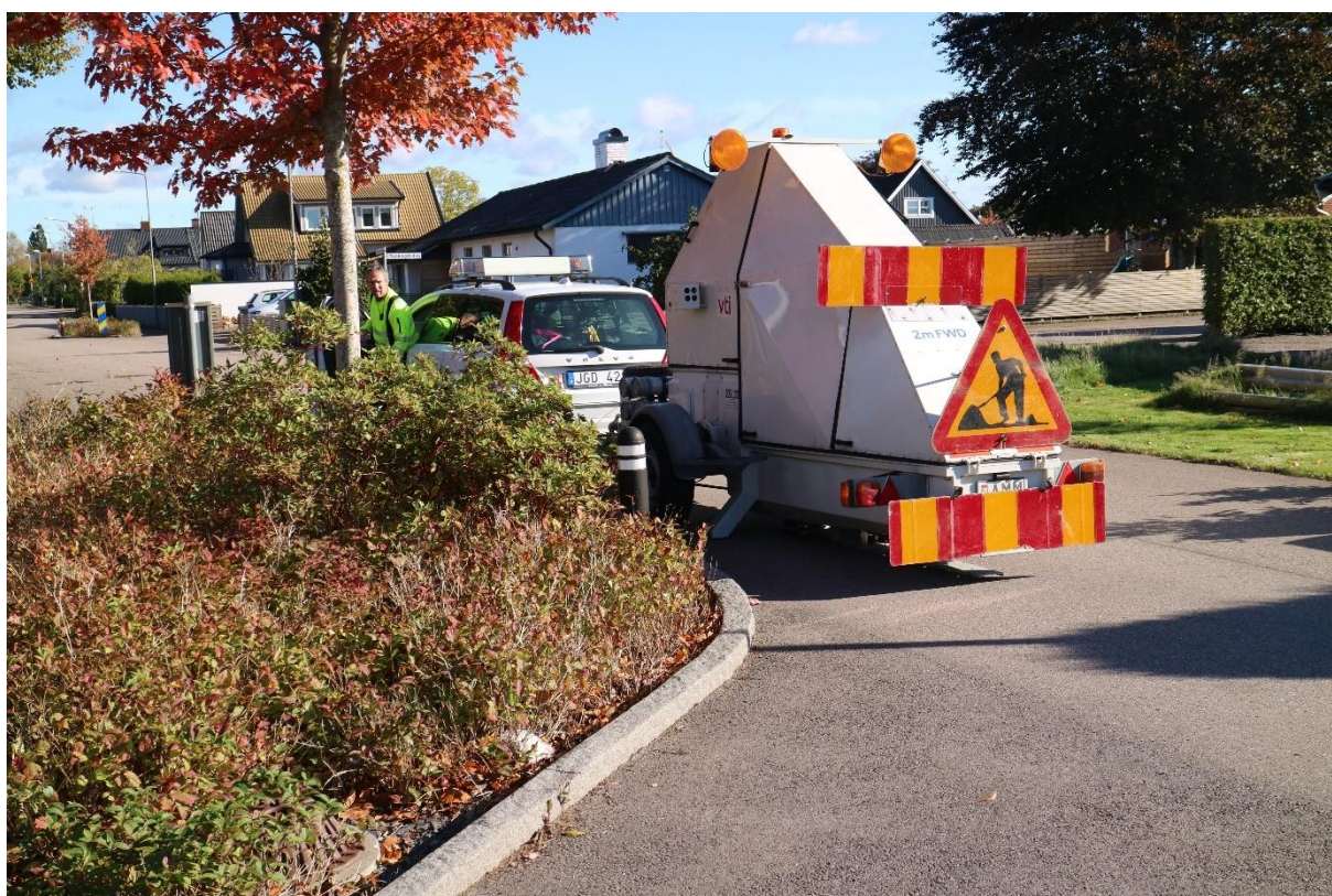
Figur 8-21. Fallviktsmätning på dränerande konstruktion i Munka Ljungby (Foto Fredrik Hellman).
