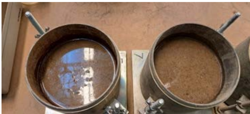
Figure 31: Prover av SVEG-jord med RS (utan konditionering) visar att vattnet inte penetrerade efter 4 timmar från tillsatsen av den sista vattenmängden under härdningen. Foto: Dina Kuttah, VTI.
