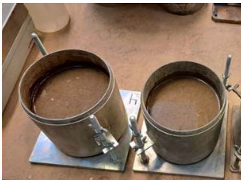
Figur 30: Prover av SVEG-jord med RS (utan konditionering) visar att vattnet inte penetrerade efter 2 timmar från tillsatsen av den sista vattenmängden under härdningen, Foto: Dina Kuttah, VTI.
