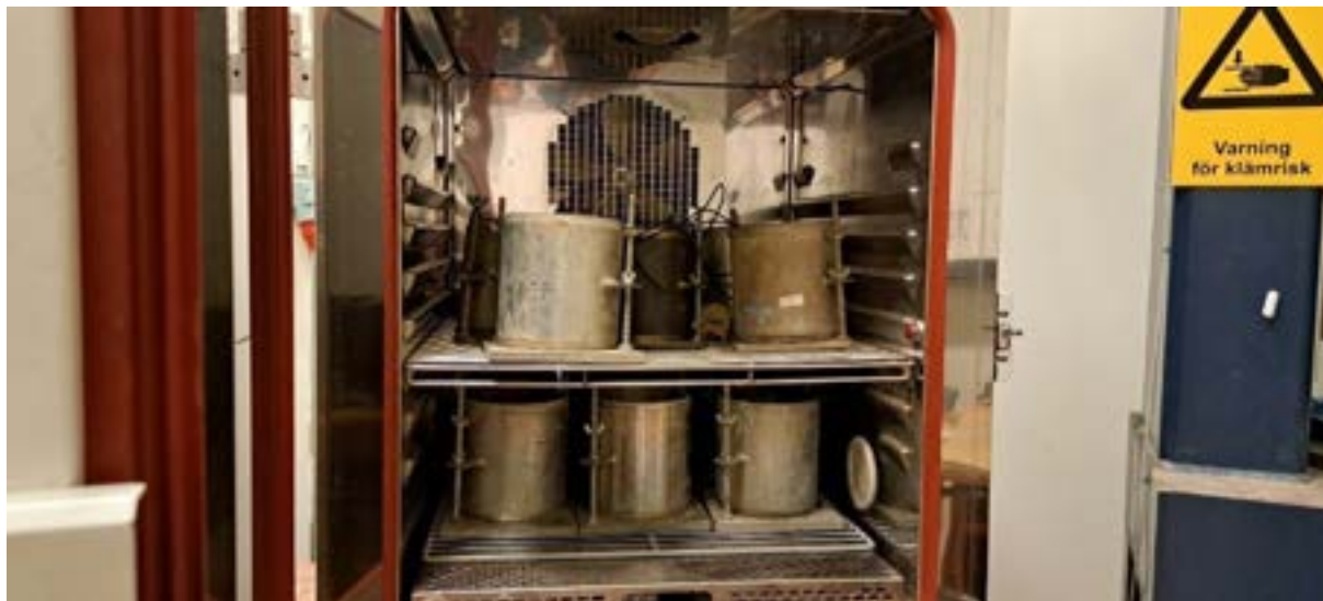
Figur 32: Konditionering av CBR-proverna i klimatskåpet under tio frys-töcykler. Foto: Dina Kuttah, VTI.
