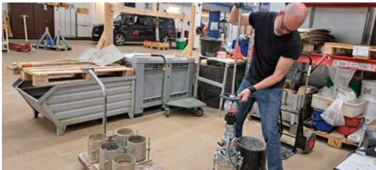
Figur 33: Dynamisk CBR-provning av packade prover. Foto: Dina Kuttah, VTI.
