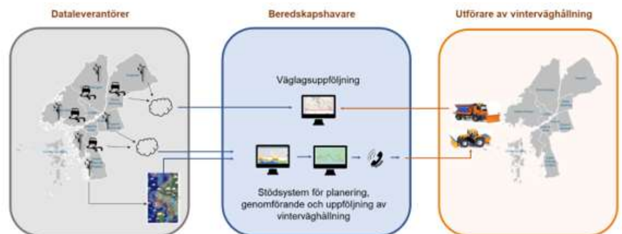
Stödsystem och informationsflöde i systemdemonstrationen.
