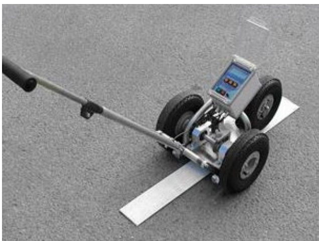
Figur 3. VTI:s portabla friktionstestare (PFT). Foto: Hejdlösa bilder
