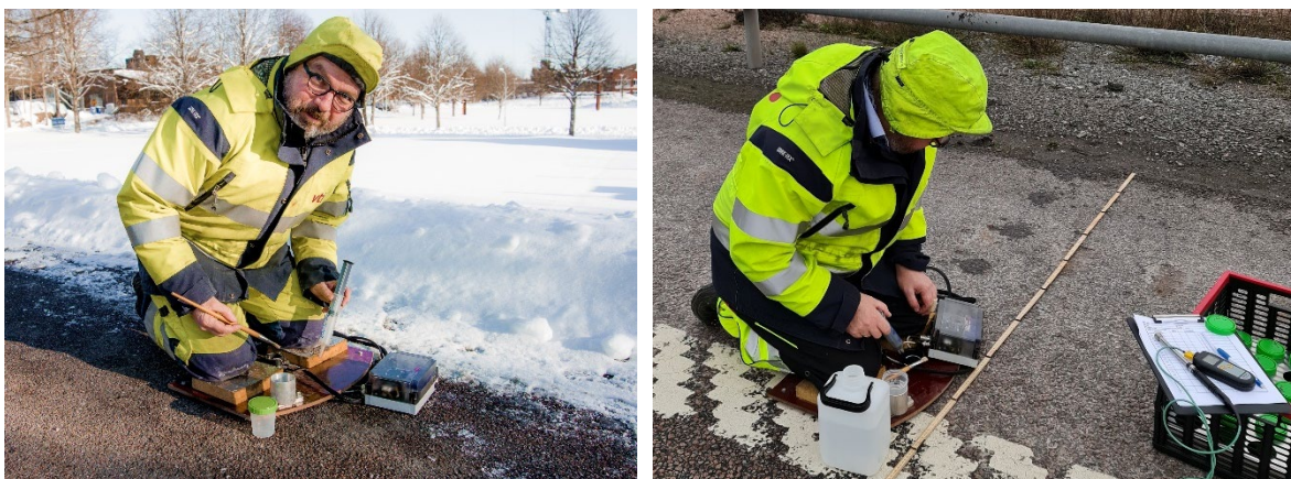
Figur 4. Prototypen till saltmätinstrumentet WSS (Wet Salt Sampler). Bild: Göran Blomqvist/Marie Junling. Bild till höger restsaltmätning från december 2020. Bild: Anna Arvidsson.
