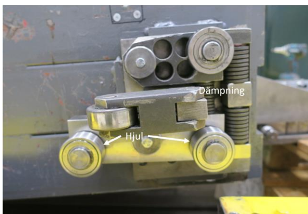
Figur 4 Slädens hjul (kullager) och dämpning.
