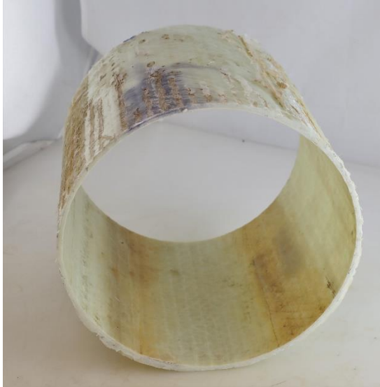
Figur 6-25. Foder med glasfiber installerat 2006 (Halmstad) med en välbevarad insida. Vattengången är mellan de två bruna fälten.
