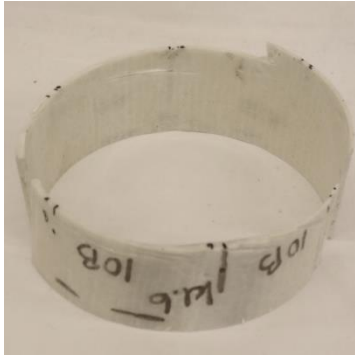
Figur 6-49. Flexibelt foder som varit driftsatt i 21 år.
