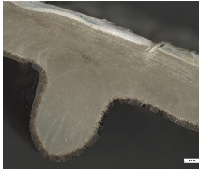
Figur 6-40. Foder som varit installerat på Tandkullevägen sedan 1995 uppvisar en krackelerad innerfilm samt en installationsdefekt i form av ett veck, men tvärsnittet är homogent utan vitning.
