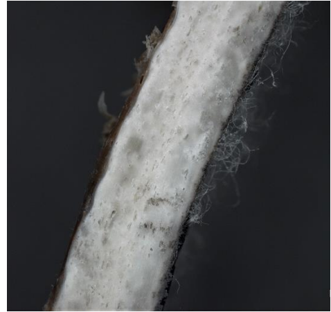
Figur 6-38. Polerat tvärsnitt från botten i samma foder som i Figur 37 med mer genomgående vitning av foderväggen.
