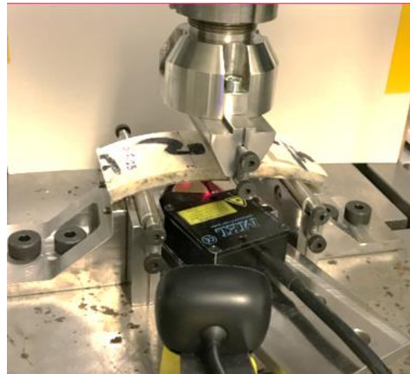
Figur 2-8. Provning av böjmodul enligt EN ISO 11296-4, Annex B).
