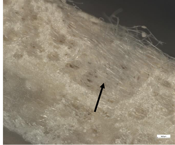
Figur 6-44. Förstoring i hjässan av fodret i Figur 42 där polyesterfilten blivit exponerad. Pilen visar den blottlagda polyesterfilten.
