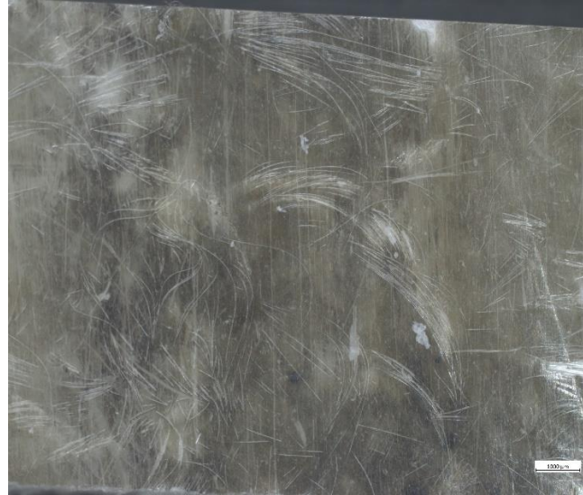
Figur 6-26. Insidan av glasfiberfoder (Öckerö #10) som installerats 1998 uppvisar endast små repor och förändringar i ytan (de som är i flödesriktningen).
