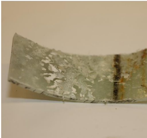
Figur 6-31. Vävfoder som uppvisar håligheter både i innerfilmen och i tvärsnittet av fodret.
