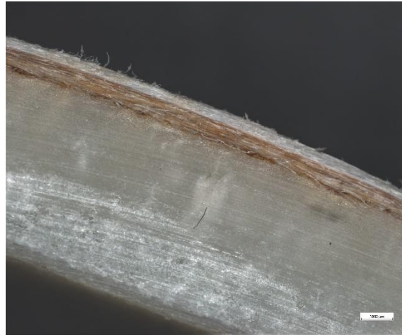
Figur 6-48. Missfärgning som breder ut sig mellan foderväggen och ytterlinern.
