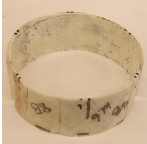
Figur 6-20. Vävfoder installerat 1998, UV-härdad, designtjocklek 3,1 mm. (Öckerö #8)
