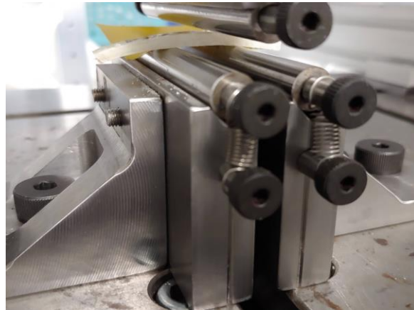
Figur 6-9. Skjuvprovning genom 3-punktsböjning av en kort balk enligt ASTM D2344.
