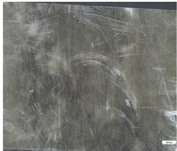
Figur 6-52. Innerytan på ett av fodren som varit i drift i 21 år
