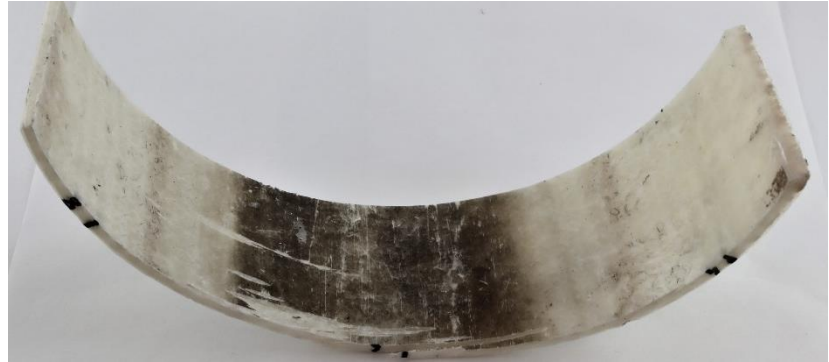
Figur 6-50. Flexibelt foder som varit i drift i 21 år där den mörka sektionen är i botten av röret.
