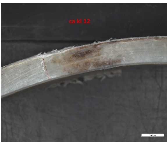
Figur 6-45. Tvärsnittet av ett foder som installerats 2007 med lokalt brun missfärgning i hjässan.
