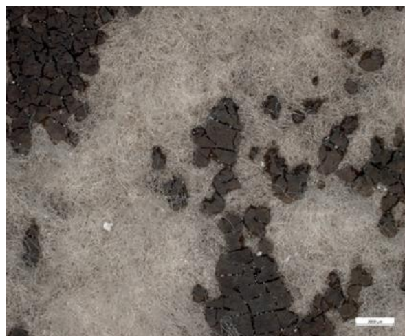
Figur 6-24. Filtfoder (Öckerö #5) efter tvättning med högtryckstvätt där den underliggande polyesterfilten blottläggs.
