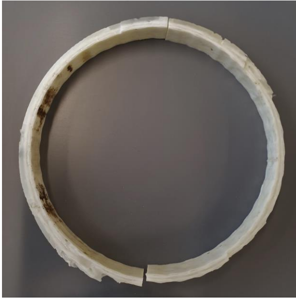
Figur 6-19. Vävfoder installerat 2007, ånghärdad med designtjocklek 4 mm. (Jasminvägen)
