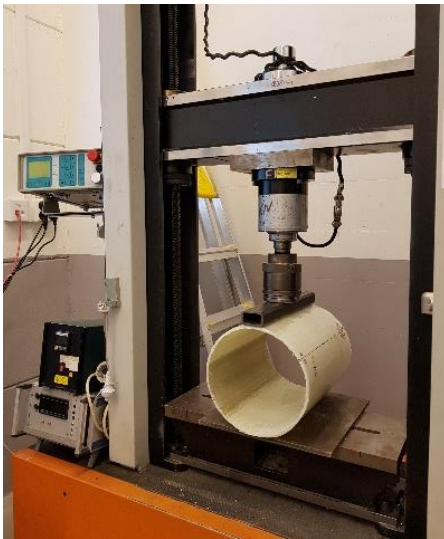
Figur 2-7. Ringstyvhetsprovning enligt ISO 7685.
