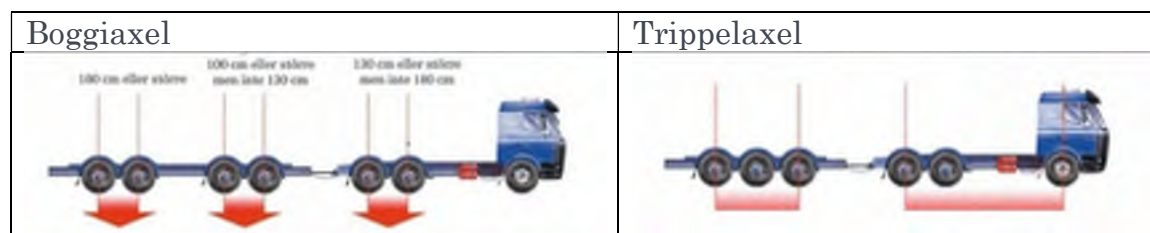
Figur 4. Principskiss över axelavstånd max boggitryck trippelaxeltryck [39].
