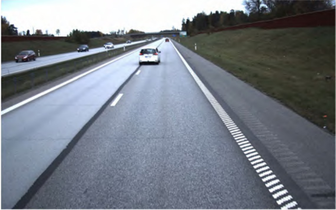
Figur 53. Foto sektion ca 23/000 för E4:an norrgående riktning förbi Uppsala, SCI_{300} \approx 8 \mu\text{m} .
