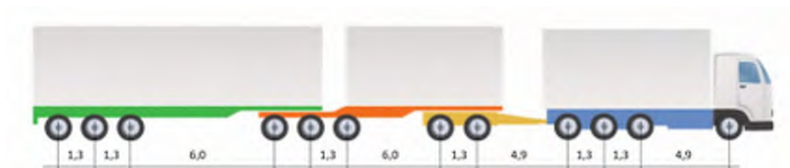
Figur 66. Tolvaxligt HCT-fordon med en tillåten bruttovikt om 98 ton, längd 34 meter [efter 9].
