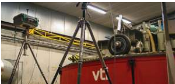
Figur 5; VTI:s provvägsmaskin för slitagestudier av vägbeläggningar (foto: VTI)
