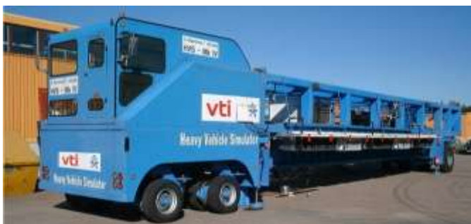
Figur 6; VTI:s Heavy Vehicle Simulator (HVS) för accelererad provning av vägkonstruktioner (foto: VTI)
