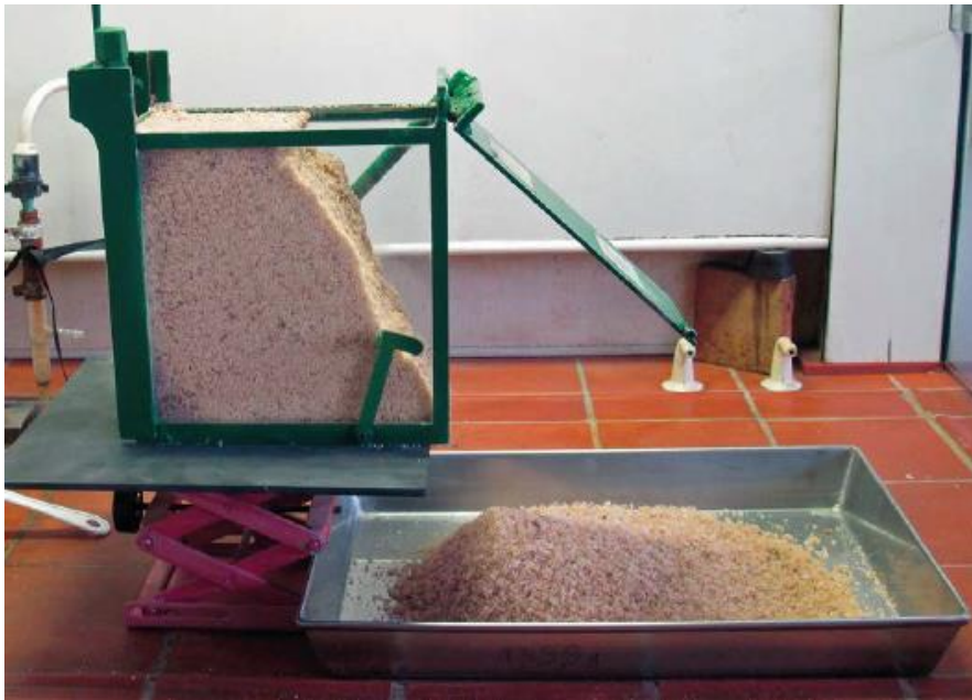
Figur 3.6: De fririnnande egenskaperna hos ett salt testas i en låda med ett "Sonntag test" (F. Götzfried, 2016).
