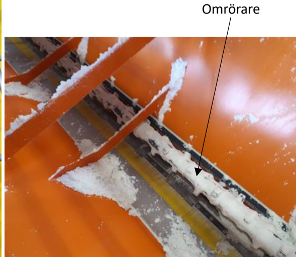
Figur 4.6: Saltkaret med galler ovanpå. Till höger ses axeln med utstickande nubb som fungerar som en omrörare (med vitt salt på).
