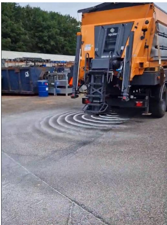
Figur 4.8: Spridning av vakuumsalt med EPOKES spridare.
