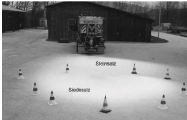
Figur 3.7: Spridningsmönster med stensalt resp. vakuumsalt vid stillastående ger olika halvmånemönster. (Badelt & Moritz BAST V186)
