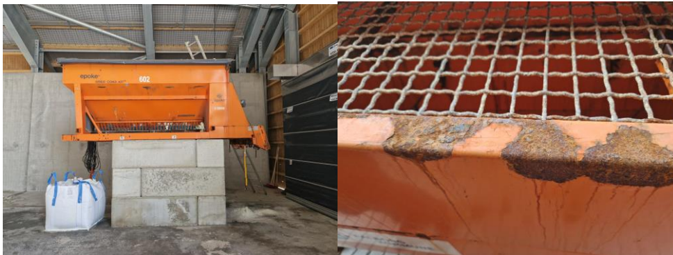
Figur 4.5: Blandningsstation för vakuumsalt och havssalt. Återanvändning av gammal spridarutrustning med band i botten.
