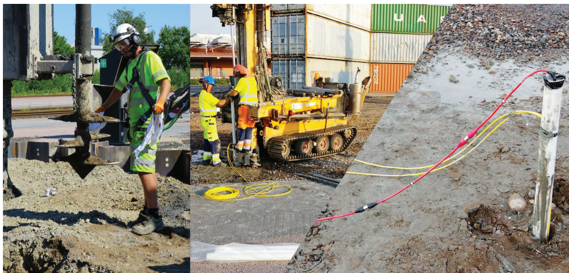
Figur 1. Första fälttester med ERT i Göteborg, sommaren 2018. Här användes ERT-kablar till för borrhålsmätning i slitsade grundvattenrör.
