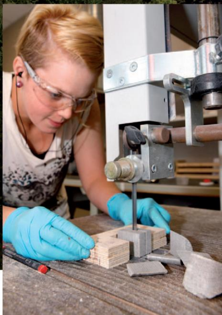
Bentonitprover förbereds i materiallaboratoriet.
