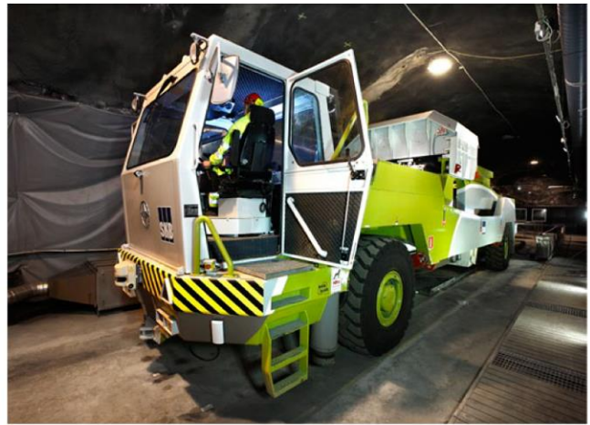
Magne, är en prototyp av den deponeringsmaskin som kommer att användas i Kärnbränsleförvaret för att sätta ner kopparkapslar i berget. Den har utvecklats och testats i Äspölaboratoriet. Fler än tusen deponeringar har genomförts med maskinen.
