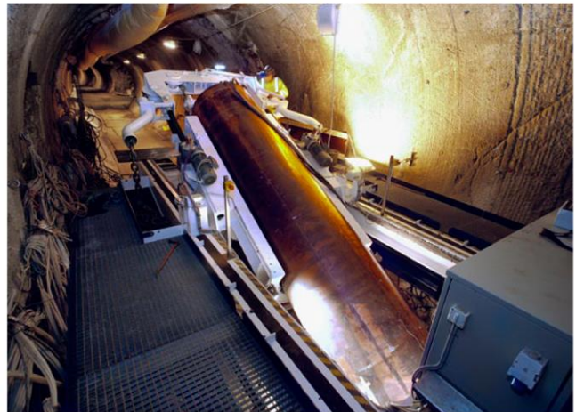
Ett av de viktigaste fullskaleförsöken är Prototypförvaret där sex fullstora kapslar har deponerats i berget.
