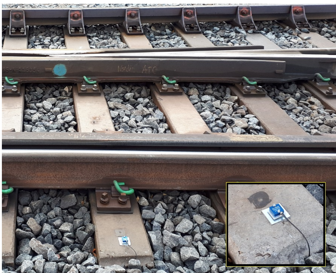
Figur 4.10: Dytran-sensor monterad på sliper med neodymbiummagnet på bricka limmad med epoxi, i Notviken, Luleå.
