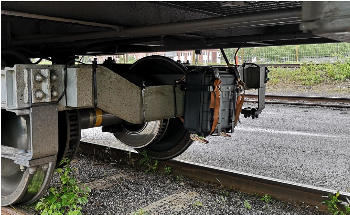
Figur 5.4: Track logger monterad på boggi.
