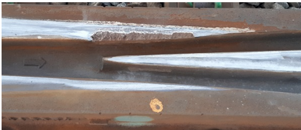
Figur 4.16: Skada i vingräl på 2 cm × 25 cm.
