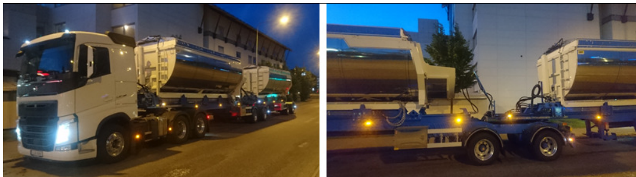
Figur 4.6 Asfaltsekipage med två linkar, benämns citylink (TFK)
