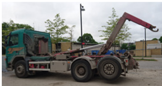
Figur 2.7 Lastväxlare med krokliift (Treiber)
