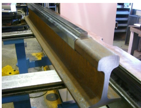
Figur 1. Montering av ReRail kappan på nedfräst standardprofil med hjälp av en kantpress.
