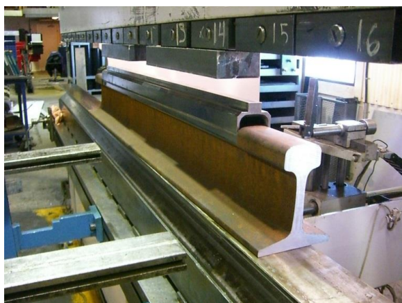
Figur 1. Montering av ReRail kappan på nedfräst standardprofil med hjälp av en kantpress.
