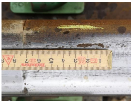
Figur 7. Ytskada observerad på ytterrälens fältsida skarv 5, till höger skadan dokumenterad via overheadkamer.
