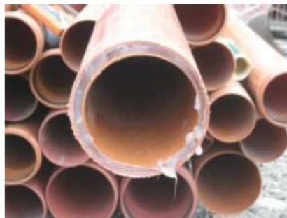
Figur 8: Materialprov kan tas i kc-pelare med metoden double-tube . Foto Yohannes och Daramalinggam (2019(a)).
