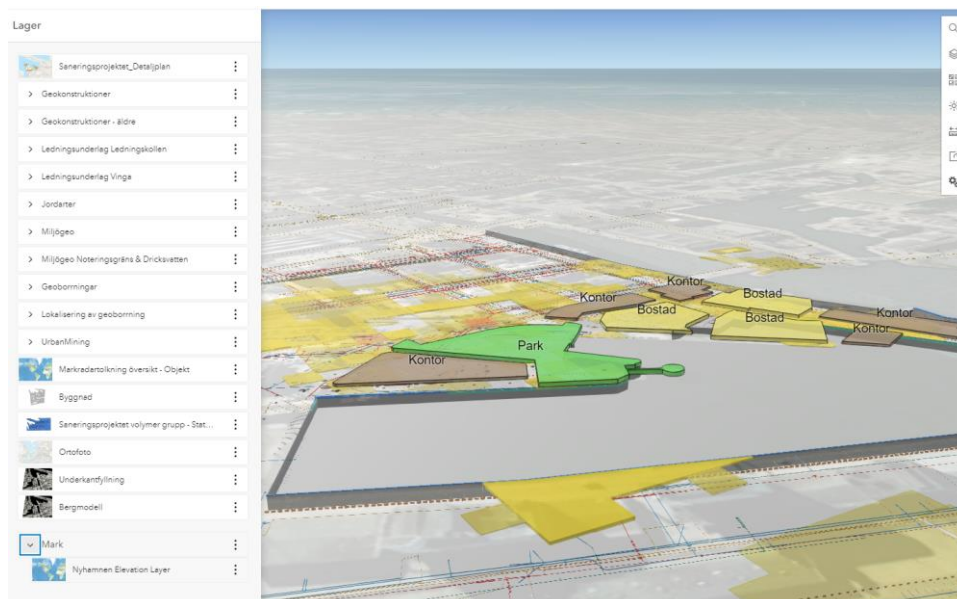
Figur 4.7 | 3D-modellen väljer användaren vilka informationsmängder som ska visas under Layers. Notera kajsponten som löper runt större delen av hamnbassängen.
