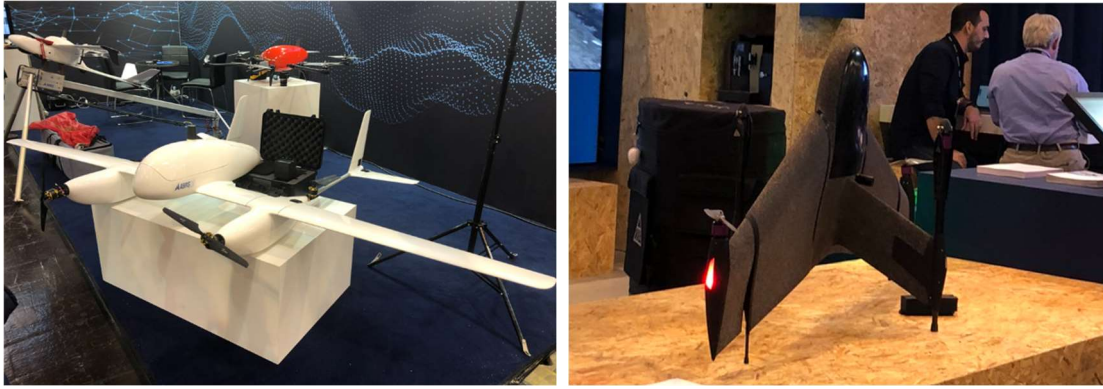
Bild 2. Exempel på hybrida UAS:er. Källa NCC, Sergio Delgado
