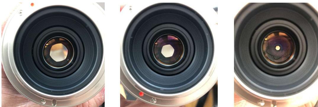
Bild 10. En bländare (och slutare) i kameran. F2.8 – F5.6 – F16. Källa: NCC, Sergio Delgado
