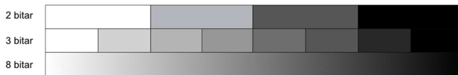
Figur 8. Illustration av radiometrisk upplösning för 2, 3 och 8 bitar. Källa: Trafikverket, Jesper klarqvist
