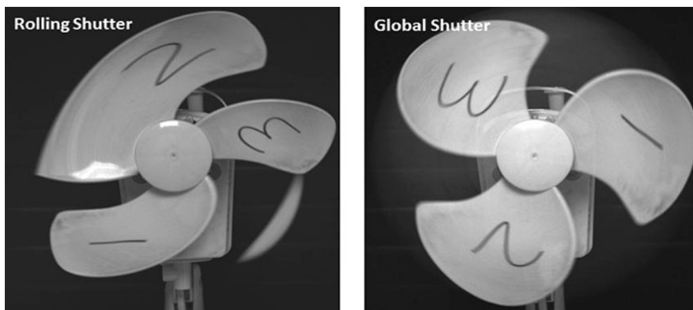
Bild 9. Illustration av en rullande slutare-effekt. Källa: www.shutterbug.com/electronic-shutters
