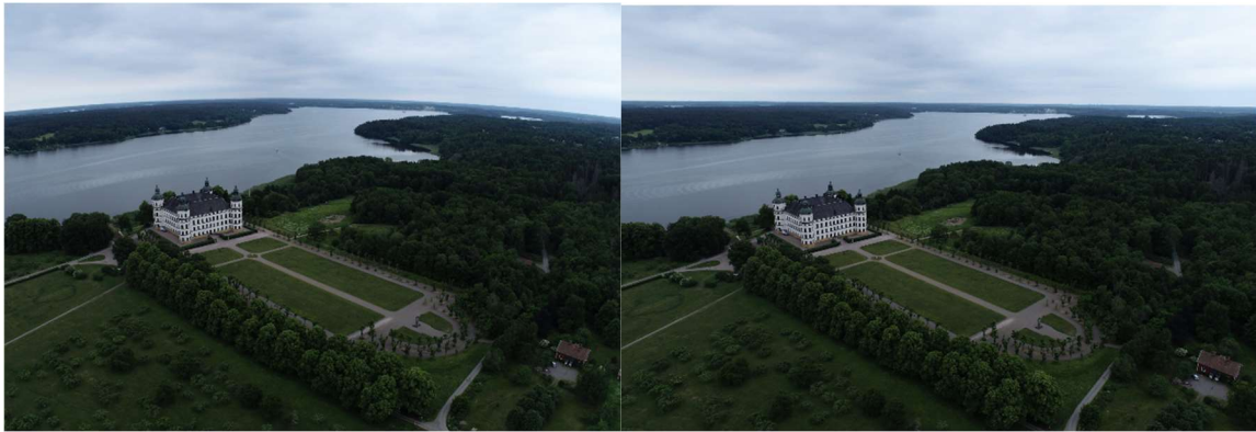
Bild 8. Till vänster: originalbild, fokallängd 24 mm. Till höger: samma bild, men som korrigerats för optisk deformation. Källa: NCC, Sergio Delgado
